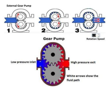
Fig. 1.2.6 (d) Working of External Gear Pump
