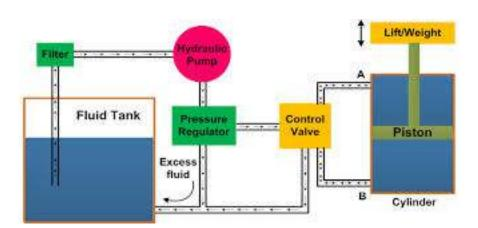
Fig. 1.2.5 (d) Pressure Flow of Hydraulics
